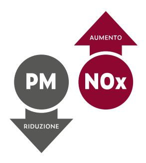
Quando il motore è a regime ottimale ai fini dell'erogazione di potenza, la produzione di PM è minima, ma i livelli di NOx sono molto elevati.
